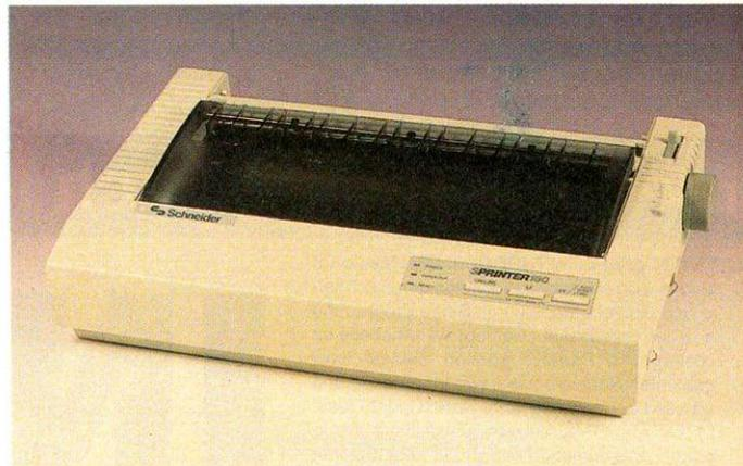
Der SPrinter 180 aus dem Hause Schneider kostet im Handel ca. 500 Mark. Er ist ein 9-Nadel-Matrix-Drucker und verfügt über einen Zugtraktor. Als Schriftzeichen stehen ihm Pica und Elite zur Verfügung. Der Anschluß an den Amiga erfolgt über die Centronics-Schnittstelle. Kompatibel ist der Schneider SPrinter 180 zum Ep-
