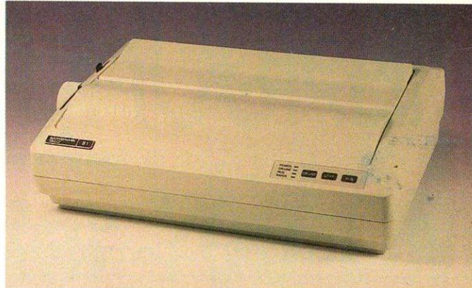
Ein optisch sehr ansprechendes Modell hat Mannesmann Tally mit dem MT 81 auf den Markt gebracht. Der Preis liegt bei etwa 400 Mark. Beim MT 81 handelt es sich auch um einen Matrix-Drucker, der mit einem 9-Nadel-Druckkopf ausgestattet ist. Auch bei diesem Gerät wird das Papier mittels eines Schubtraktors vor den Druckkopf
